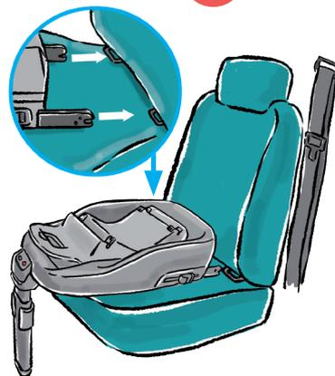
Cliquez les fixations du système sur les anneaux Isofix du véhicule. (Les indicateurs de connexion, jusqu'alors rouges, deviennent verts).
